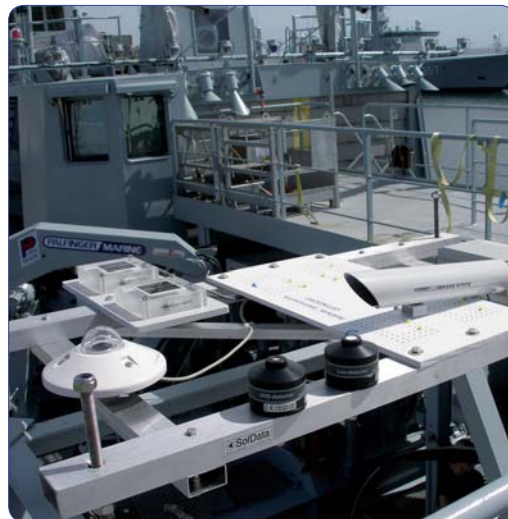
Figur 2: Optikbordet er en aluramme monteret på et stålbord, der er svejset fast ovenpå Vædderens hydrologilaboratorium.
